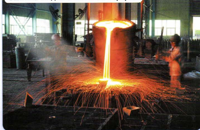
Заливка жидкого металла в формы
