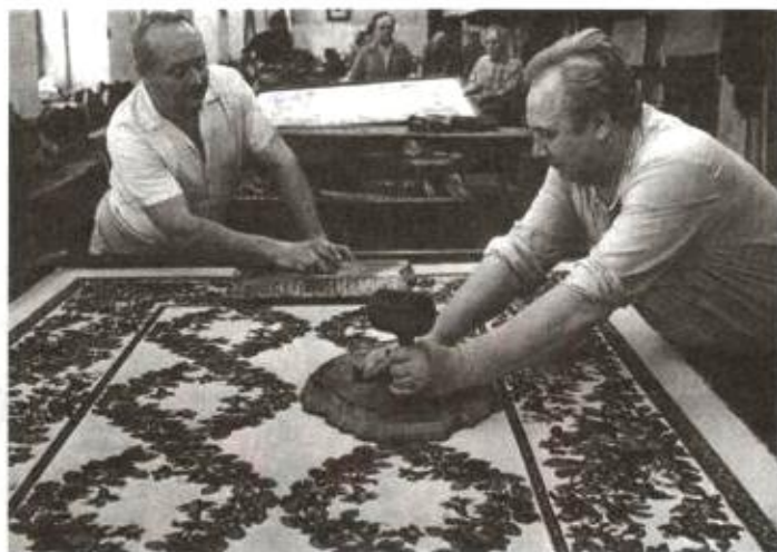
Приёмы ручной набойки на современном производстве
