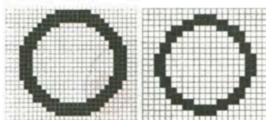
Рис. 3.1. Изображения высокого и низкого разрешения
