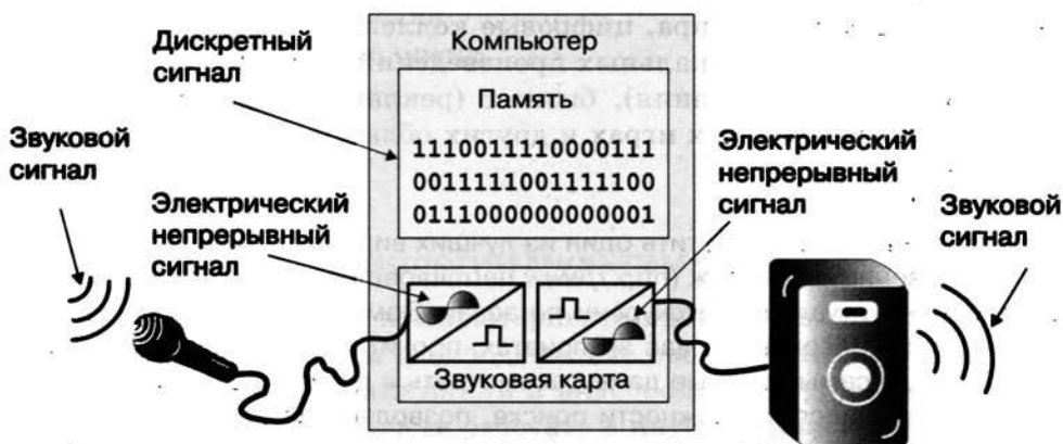
Рис. 5.1. Преобразование звука при вводе и выводе
