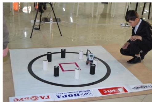
Робота оснастили датчиком освещённости, расположив его на кронштейне слева от корпуса в передней части тележки. Программа управления составлена из двух частей: в первой части задано движение по крутой дуге с выходом тележки от центра к внешнему краю, вторая часть программы обеспечивает движение тележки вдоль окружности с контролем черной линии.
